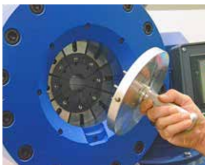
Sfilare Impugnatura cambio rapido
