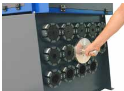
Inserire l'utensile nella serie di morsetti prescelta
