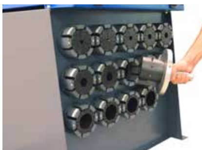
Ruotare e togliere la serie di morsetti
